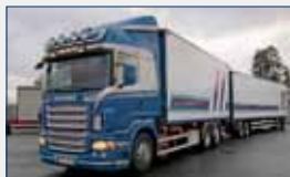
Scania R560LB 6x2 MNA 2007 95.000 mil, highline Opticruise, retarder, släp MST -06, 18-20 boggi, byggnation Eksjö maskin & truck. Tj vikt bil & släp 20.860 kg.
