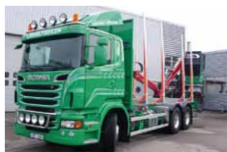
Södra Skogsägarna valde ytterligare en Scania. En R560LB6x4 med CR16 hytt och hjulbas 4300 mm. Påbyggnation från Bergs Smide i Fegen med Logglift 96S skogskran.
